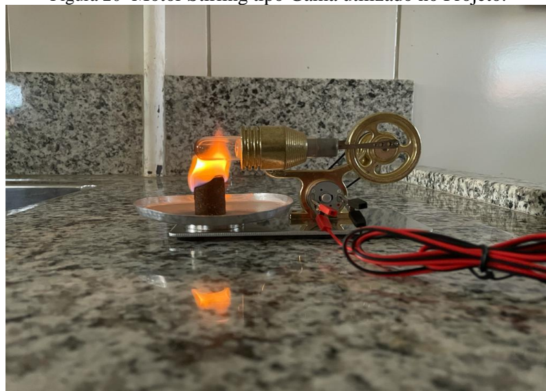
Figura 20- Motor Stirling tipo Gama utilizado no Projeto.
