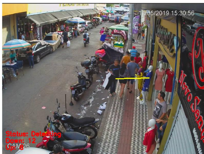
**Figura 3.11:** Exemplo de execução do componente de contagem de pedestres.
