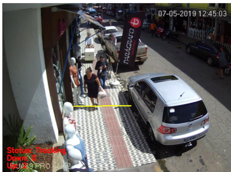
**Figura 3.13:** Escolha do segundo ponto na imagem, de modo que se possa traçar uma reta para a delimitação da área de contagem.
