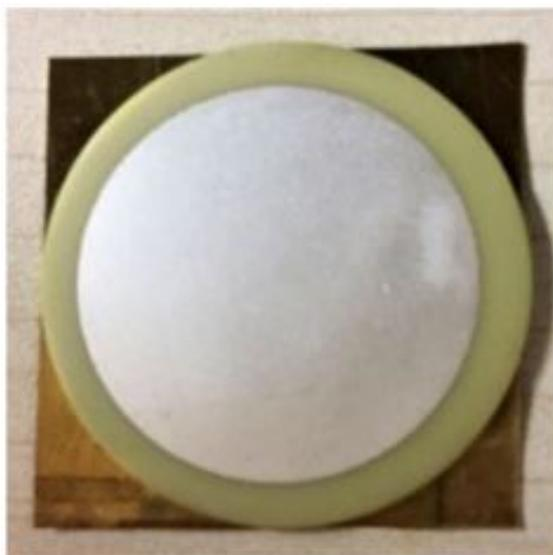
**Figura 2.1:** Imagem de um sensor PZT-5H.
