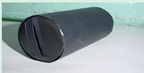
**Figura 3 - Espectroscópio caseiro simples (BROCKINGTON, 2005)**
