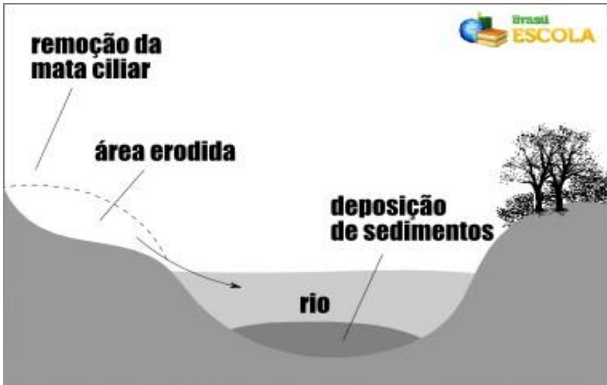
FIGURA 2 - Esquema de uma área assoreada, com sedimentos sendo depositados
